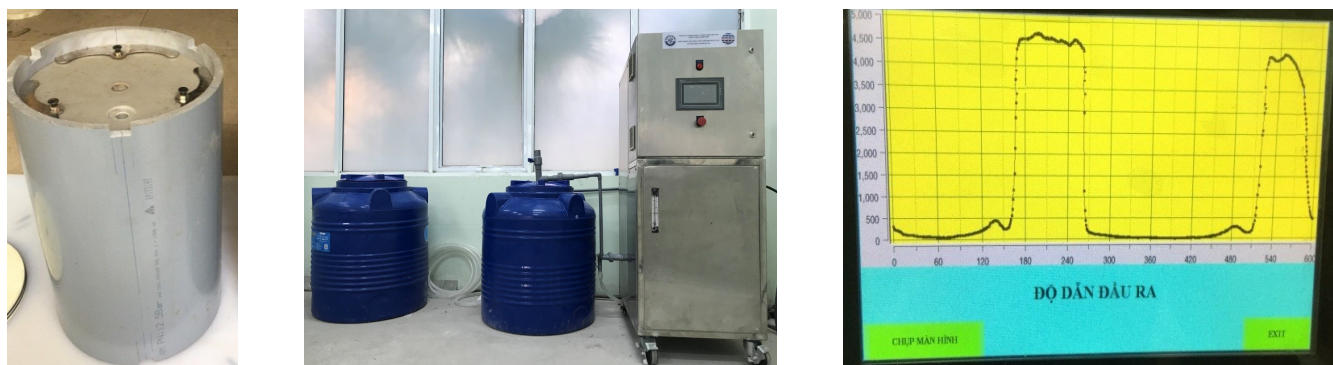
Hình 4. Module MCDI, hệ thiết bị prototype MCDI xử lý nước lợ và màn hình điều khiển (ảnh theo thứ tự từ trái qua phải)
