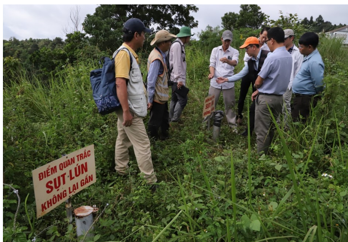
Điểm quan trắc sụt lún của Viện Địa chất, Viện Hàn lâm KHCVN (kết quả nghiên cứu khoa học đề tài TN18/T13, thuộc Chương trình Tây Nguyên 2016- 2020) đặt tại đường Trần Hưng Đạo đo được độ dịch chuyển ~ 168mm ở độ sâu 39,5m (16/8/2023) so với thời điểm bắt đầu đo (07/01/2020).
