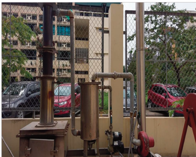
Hình 2. Hình ảnh thực tế hệ thống lò đốt NFIC 50kg/ngày
