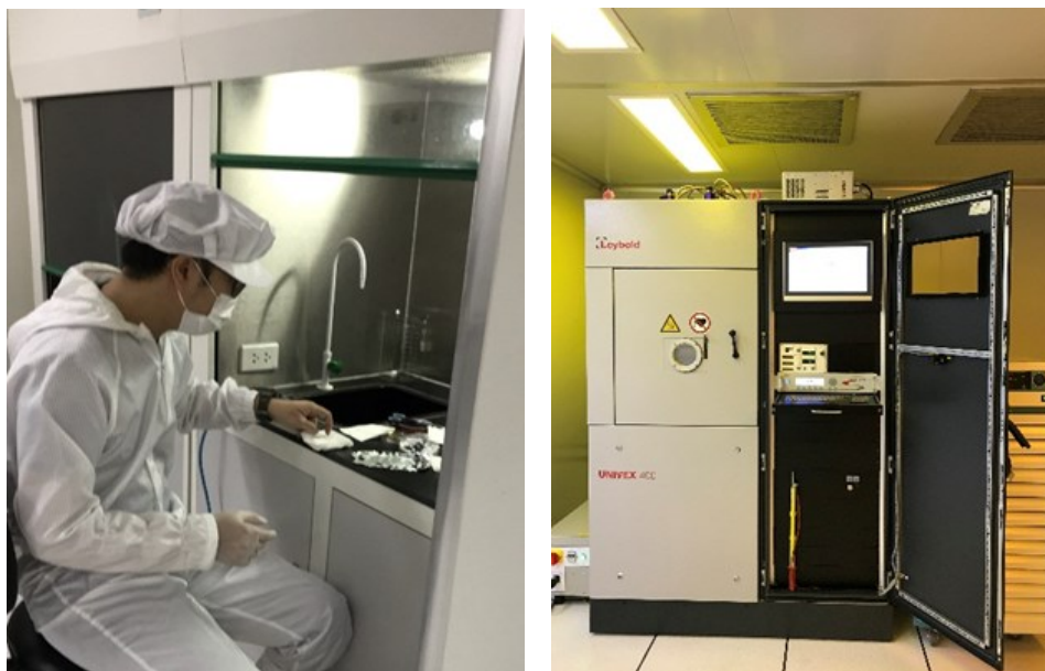
Hình 1. Chuẩn bị bề mặt mẫu hợp kim Ti6Al4V và thiết bị phun xạ magnetron Univex 400 tại Viện Khoa học vật liệu
