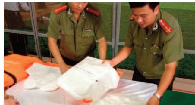
Kiểm tra kết quả áo phao sau khi bắn thử nghiệm
