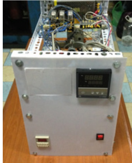
Thiết bị thử nghiệm làm lạnh bằng từ trường ở vùng nhiệt độ phòng dựa trên hiệu ứng từ nhiệt.
