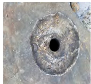
Tấm thép 40Cr dày 130mm (trái) và lỗ do lõi xuyên tạo ra trên tấm thép khi bắn (phải)
