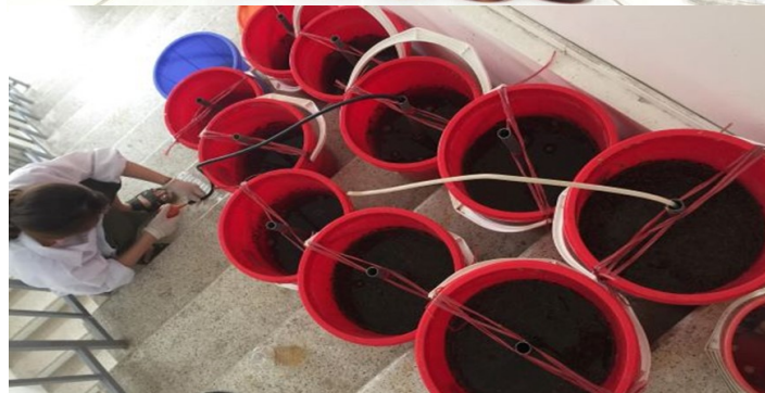
Hình 3. Quy trình công nghệ xử lý nước thải mỏ than bằng phương pháp chuyển hóa sinh học kết hợp với bãi lọc trồng cây nhân tạo
